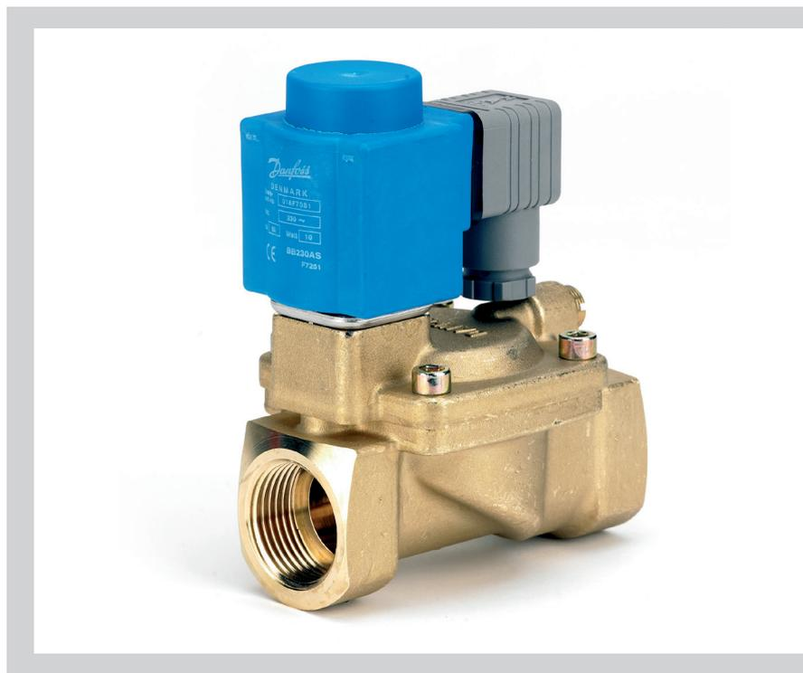
EV220B 15–50 é um programa universal de válvula solenoide de 2/2 vias indiretamente servo-operada. O corpo da válvula em latão, latão resistente à dezincificação e aço inoxidável garante que uma ampla variedade de aplicações podem ser cobertas. Filtro piloto integrado (padrão), tempo de fechamento ajustável e grau de proteção até IP67 garantem desempenho ideal mesmo em condições críticas de trabalho.
